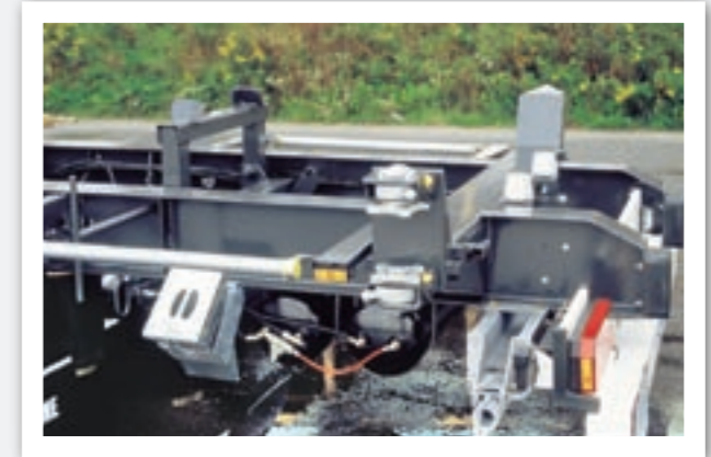
Ausstattung Zentralachsenanhänger. Für Volumen- und Standardpritschen eignet sich der Zentralachsenanhänger mit höhenverstellbaren Eckbeschlägen und versenkbaren Füllböcken, beides bequem mit Drehmechanik.
