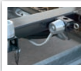
Umsteckbare Zentrierrollen. Umsteckbare Zentrierrollen erlauben auch die Aufnahme von ISO-Containern.
