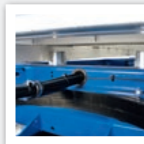
Umsteckbare Zentrierrollen. Umsteckbare Zentrierrollen erlauben auch die Aufnahme von ISO-Containern.
