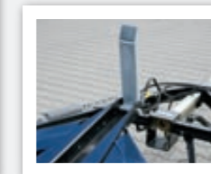
Stabile Anschläge. Klappbare, robuste Anschläge ermöglichen passgenaues Aufpritschen der Wechselbehälter.
