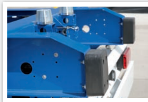
Durchdachte Aufpritschlösung. Die Ansträgungen der Längsträger am Heck erleichtern das Aufpritschen auf unebenem Gelände, wenn die Zentriertunnel der Pritschen niedriger stehen als die Chassisrahmen einfahren können.
