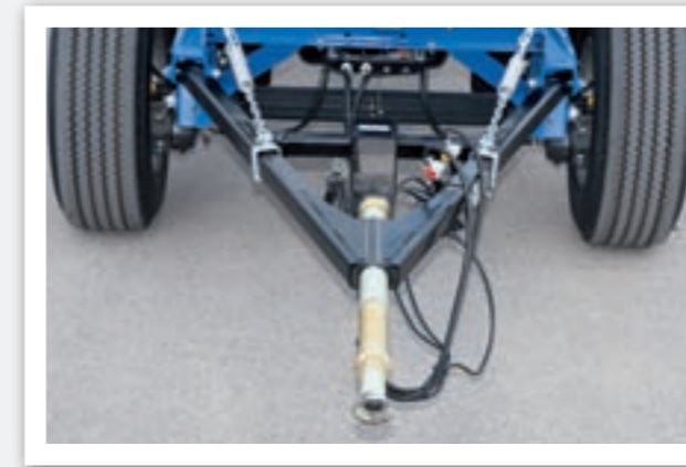
Wartungsarmes Equipment. Wartungsarmer Kugeldrehkranz und Zuggabel mit Silentbuchsen und Höheneinstellvorrichtung gemäß UVV.
