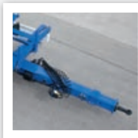
Verschraubter Zugholm. Der Zugholm ist mit dem Fahrgestell verschraubt. Das senkt die Kosten im Falle eines Austauschs. Die Zugöse ist achtfach verschraubt und somit hinreichend gesichert.
