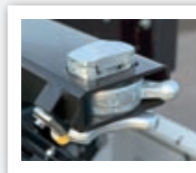
Ausziehbare Zuggabel. Die teleskopierbare Zuggabel für unterschiedliche Kupplungsrücksprünge an Zugfahrzeugen (optional).
