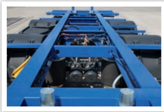
Zentrierrollen aus Stahl. Kugelgelagerte Zentrierrollen aus Stahl erleichtern die Pritschvorgänge.
